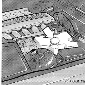
**Vorratsbehälter der Reinigungsanlage für Scheiben, Scheinwerfer und Nebelscheinwerfer \* – BMW 750i/L**
